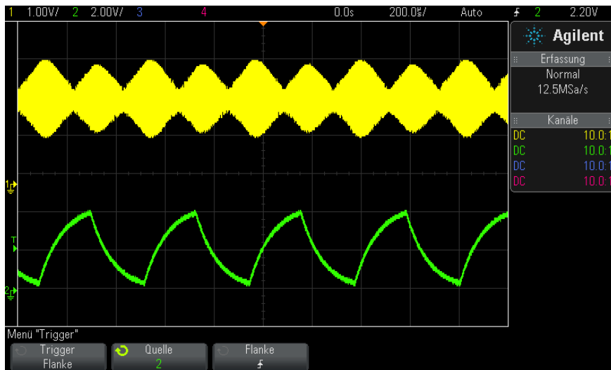
Abbildung 25 Amplitudenmodulation bei 100% Intensität
