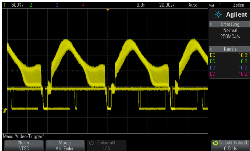
Abbildung 28 Triggerung auf alle Zeilen
